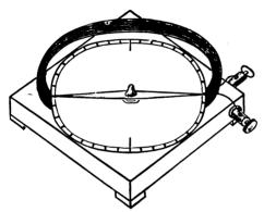
FIG. 143.-Galvanometer complete.
